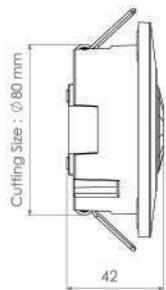
سنسور حرکتی صبا، طراحی شده برای بهینه‌سازی مصرف انرژی در مکان‌های پر تردد مانند راه‌پله‌ها، پارکینگ‌ها و ... در دو مدل رادیویی (MICROWAVE) و مادون قرمز (PIR) به صورت توکار و روکار قابل ارائه است. با ورود افراد به میدان دید سنسور، چراغ‌های متصل به آن به صورت خودکار روشن شده و پس از گذشت زمان تنظیم‌شده خاموش می‌شوند. این سنسور همچنین قابلیت تشخیص روز و شب و تنظیم حساسیت به نور محیط را در هر دو مدل دارد، که این ویژگی‌ها موجب افزایش کارایی و کاهش مصرف انرژی می‌شود.
