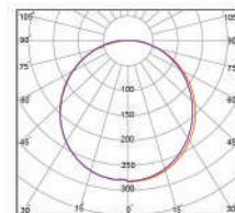
چراغ مدل دینا با طراحی خاص و زیبا، گزینه‌ای مناسب برای روشنایی فضاهای سرپوشیده مانند اداری، تجاری و عمومی است. این محصول با زاویه پخش نور ۱۲۰° درجه روشنایی یکنواخت و گستردگی را ارائه می‌دهد. استفاده از چیدمان LED ها به سبک BACKLIGHT است. بهره‌وری و کیفیت نور این چراغ را بهبود بخشیده است. با درجه حفاظت IP52، این چراغ مقاوم در برابر گرد و غبار است. همچنین، چراغ دینا در سه رنگ نور آفتابی، طبیعی و مهتابی قابل سفارش بوده و با نیازهای مختلف روشنایی سازگار می‌باشد.
