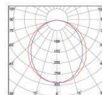
چراغ درناز یک چراغ دکوراتیو به صورت آویز خطی است که به دلیل شار نوری بالا و ظاهر زیبا، مناسب استفاده در فضاهای مسکونی، تجاری، اداری و عمومی می‌باشد. این چراغ در توانهای مختلف با ضرب ۲۴ وات عرضه می‌شود. جنس بدنه از OSRAM آلمانیوم است و در تولید آن از شرکت بهره گرفته شده است. این محصول با درجه حفاظت IP54 و زاویه تابش ۱۲۰ درجه، درسه رنگ نور طبیعی مهتابی و آفتابی قابل سفارش می‌باشد.
