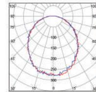
چراغ مدل دنیز با طراحی دقیق و استفاده از LED های شرکت OSRAM، هیت سینک آلومنیومی و بدنه ABS، کیفیت بالا و طول عمر زیادی دارد. این چراغ با قطر برش ۵ سانتی‌متر و راندمان نوری عالی، گرینه‌ای مناسب برای روشنایی محیط‌های مسکونی، اداری و تجاری است. زاویه تابش ۱۲۰° درجه، نور را به صورت یکنواخت پخش می‌کند و درجه حفاظت IP52، مقاومت آن را در برابر گرد و غبار تضمین می‌کند. این محصول در سه رنگ نور آفتابی، طبیعی و مهتابی قابل سفارش است و انتخابی کارآمد و زیبا برای فضاهای داخلی محسوب می‌شود.
