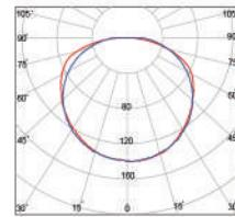
چراغ خطی و توکار مدل درنیکا با نصب سریع و آسان و پخش نور یکنواخت، برای فضاهای اداری، مسکونی، تجاری و درمانی ایده‌آل است. استفاده از LED شرکت OSRAM باعث افزایش راندمان نوری آن شده و زاویه تابش ۱۲۰ درجه، پخش یکنواخت نور را تضمین می‌کند. بدنه چراغ‌ها در عرض‌های ۱,۵ سانتی‌متر، به صورت آنودایز شده تولید می‌شود.
