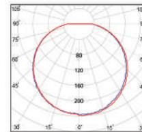
چراغ روکار طرح آیسان با بدنه ABS و دیفیوزر پلی استایرن طراحی و تولید گردیده و درجه افزایش راندمان و طول عمر آن از LED شرکت OSRAM استفاده شده است. طراحی این محصول به گونه‌ای است که علاوه بر ظاهري زیبا، پخش نور ۱۴۰ درجه‌ای را نیز فراهم می‌نماید. لازم به ذکر است که این چراغ در دو مدل IP65 و سنسوردار قابل تولید می‌باشد. این محصول با ابعاد ۱۵×۱۵ سانتی‌متر و درجه حفاظت IP۵۴ ازایه می‌شود و در سه رنگ نور طبیعی، مهتابی و آفتابی قابل سفارش است.
